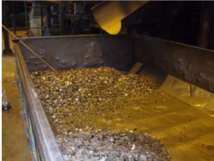
Figura 2. Contenedor de recepción del residuo desde las mesas densimétricas.
