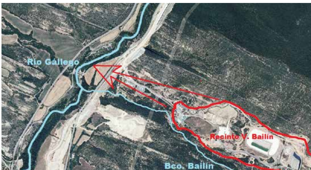
Fluxo de lixiviados dende vertedoiro de Bailín cara o río Gállego.
