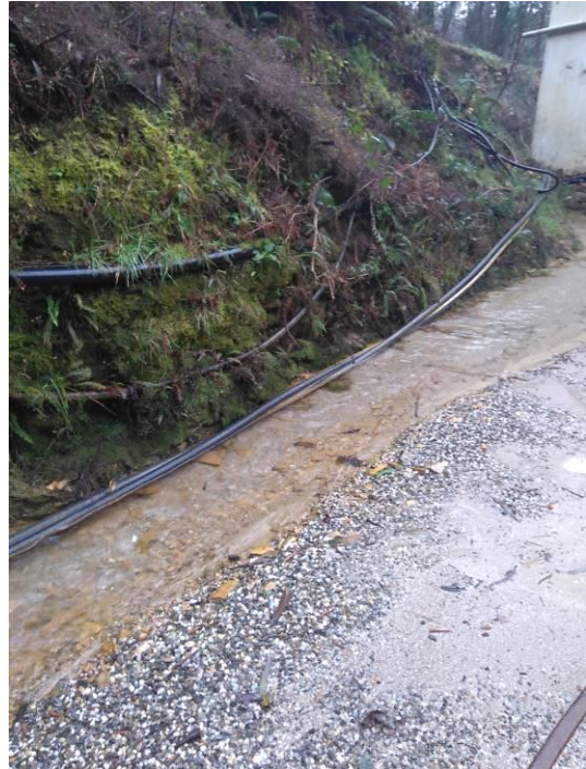
Foto 14 – Detalle das augas que saen do nivel 4 de Buenaventura, e que se corresponden principalmente coas provenientes do nivel 6 de Pozo Nuevo, debido ao sistema de vasos comunicantes existente. Procédese á mostraxe M-DC-JPR-080216-A2 (V-17944)
