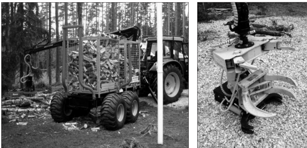
Figura 8. Equipos de tala, tronzado e fendido no monte.
