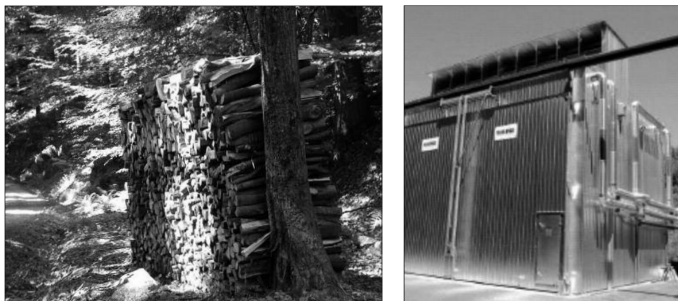
Figura 10. Secado ao aire libre (esquerda) e secado artificial (dereita).
